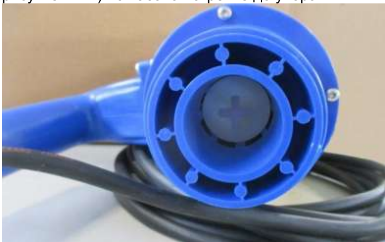
Рисунок №7. Узел присоединения со стороны э/двигателя.
